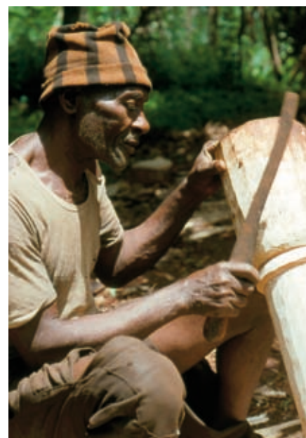
Mit dem Buschmesser formt der Trommelbauer Kiefeh Wembai das Rundholz zu einem Trommelkörper.
